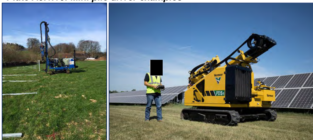
Plate A9.1.16: Mini pile driver examples
